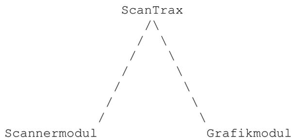
ScanTrax (Hauptprogramm) ist der Kontrolleur von zwei Modulen. Das Programm selbst, läuft auf einer MC68020+ CPU oder höher.
